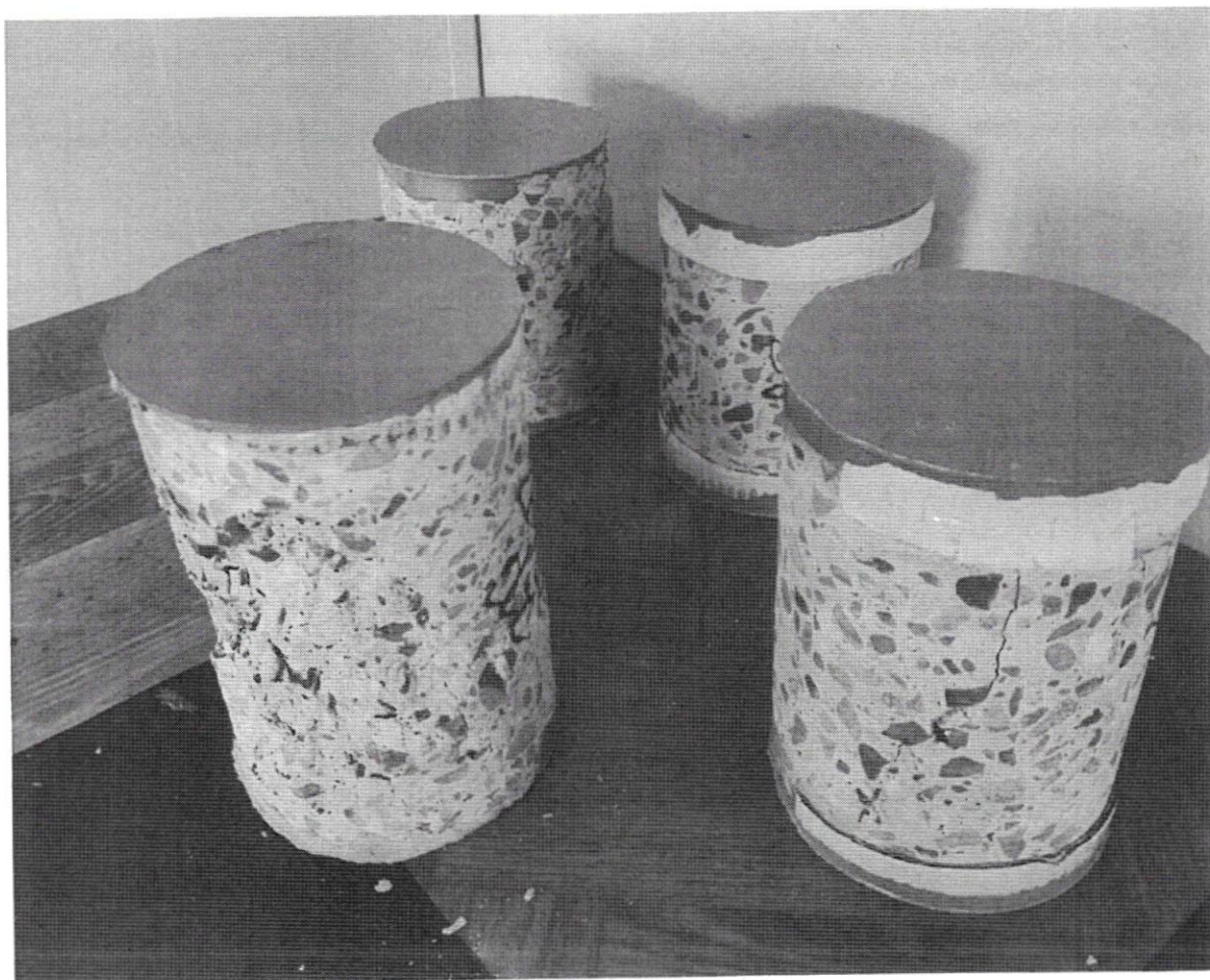
Figura 17. Încercarea betonului la rezistența la compresiune cu presa.
